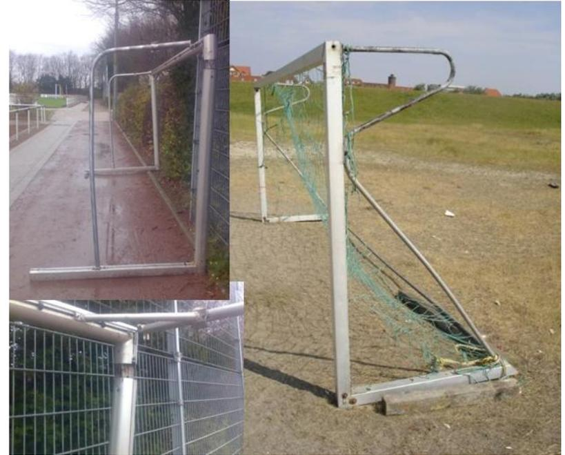
„Zerlegbare“ oder „teilverschweißte“ Tore halten den hohen Belastungen nur unzureichend stand, sie sind aufgrund des Transportes und der Fertigung „billiger“ als vollverschweißte Tore!
