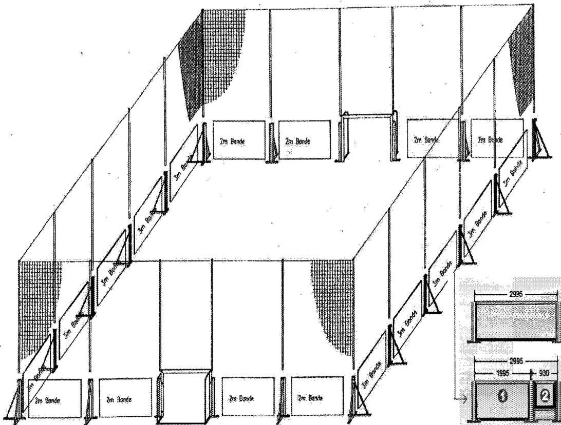
Soll an einer Längsseite des Courts statt einer 3m Bande ein Türelement eingebaut werden, kombiniert man folgende Elemente:
